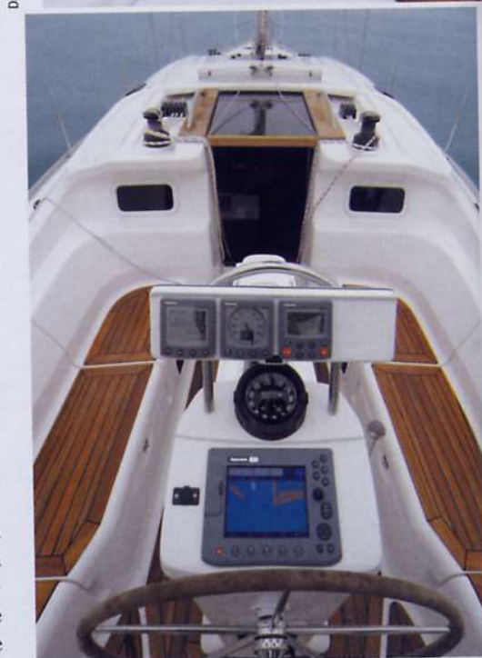
Sopra, l'imponente colonnina strutturale del timone con la consolle portastrumenti e il piano d'incasso per il chartplotter.
